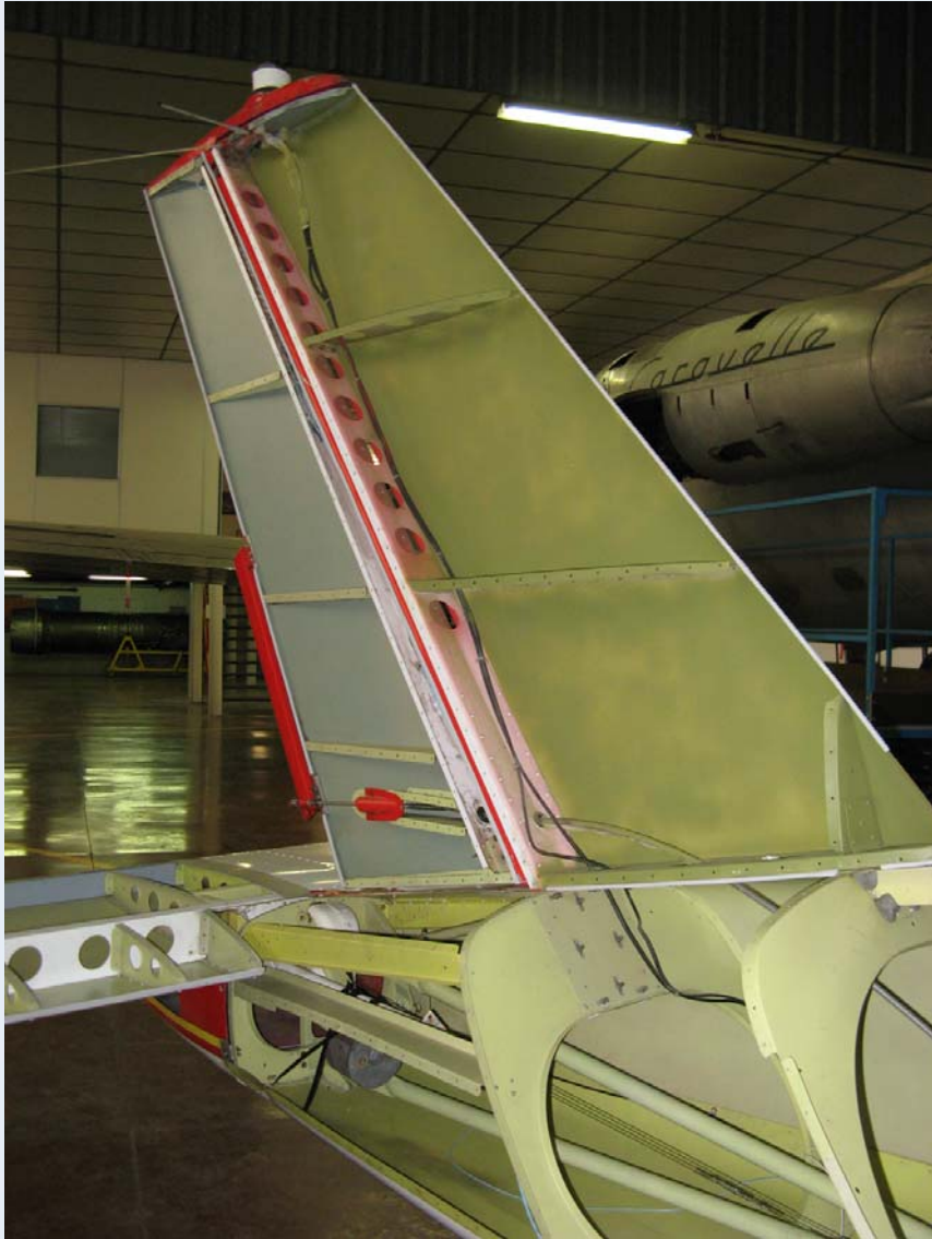
Structure d'un empennage.
